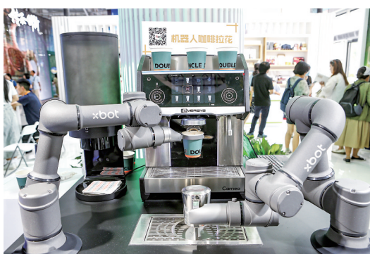
这是9月5日在服贸会首钢园区拍摄的一款自主研发的双机械臂咖啡机器人。该机械臂采用视觉定位和运动控制算法,运动精度达到亚毫米级。
